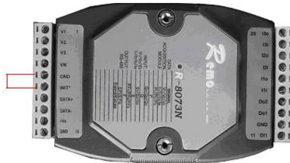
图 2-3: 短接 INIT 与 GND 端子示意图
