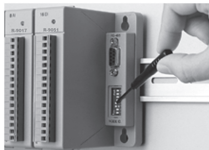
节点ID设置 8位拨码开关设置
