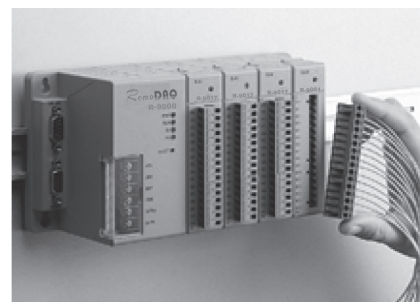
接线 插入预先接好的I/O模块端子
